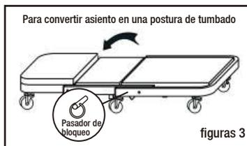
Paso 3. Desbloquee el bloqueo del eje con resorte, estirando hasta desencajarlo, después, revierta los pasos 1, 2 para convertir la camilla-asiento en camilla.
