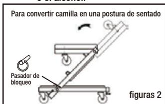
Paso 1. Localice, y después desbloquee el bloqueo bajo carga de resorte, estirando hacia fuera hasta que desencaje, al mismo tiempo volteé el cabezal del resorte y el cuerpo del resorte hacia arriba y de vuelta, hacia atrás, hacia la sección del resorte trasero hasta que el bloqueo del eje pueda bloquear la funda del asiento pasador de la camilla (Figura 3). Asegúrese que el bloqueo del eje esté completamente conectado.
