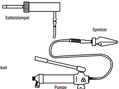
Für eingengeigte Bereiche sollte der hydraulische Spreizkeil verwendet werden.
