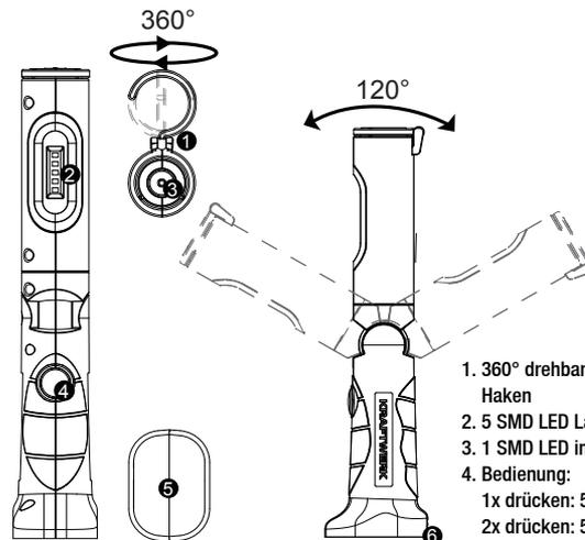
1. 360° drehbarer und klappbarer Haken
